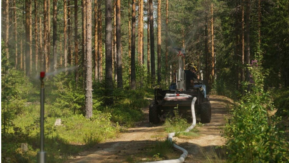
Kuva 8. Kuvassa Marko Hassisen kehittämä sadetinkärri, jonka avulla saadaan luotua nopeasti sammutus- ja rajoituslinja maastopaloihin. Kuva: Luomustudio Productions Oy.
